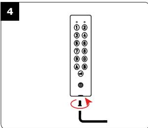
Bloquez le PROFIL100EC sur son support par l'intermédiaire de la vis Diax® et de son outil spécifique (clé mâle coudée). Pour finaliser le montage de ce produit, placez le cache-vis.
