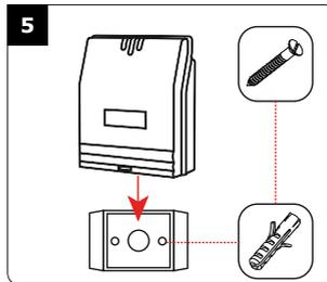
Positionnez les 2 chevilles plastiques dans les trous. Puis fixez la plaque de fixation de l'électronique déportée sur la surface de votre choix, à l'aide des vis. Venez ensuite placer l'électronique déportée sur son support.
