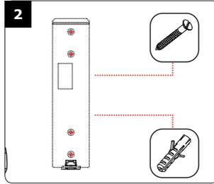
Positionnez les 2 chevilles plastiques dans les trous. Puis fixez le fond du PROFIL100EC sur le support de votre choix, à l'aide des vis cruciformes à têtes fraisées.
