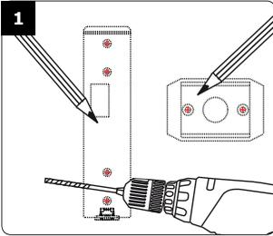
Vérifiez la distance entre le PROFIL100EC et son électronique déportée (Voir page 12 « Rappels et préconisations »). A l'aide de la plaque de fixation de l'électronique déportée et du PROFIL100EC, prenez les marques et percez les 2 trous de fixation (forêt Ø 5 mm et profondeur minimum = 35 mm) ainsi que l'ouverture pour le passage du câble électrique destiné au clavier.
