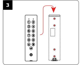
Passez le câble électrique du PROFIL100EC dans son ouverture et fixez le à son support par le haut avec le crochet supérieur.
